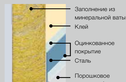
Заполнение из минеральной ваты (опция) для улучшения теплоизоляции
